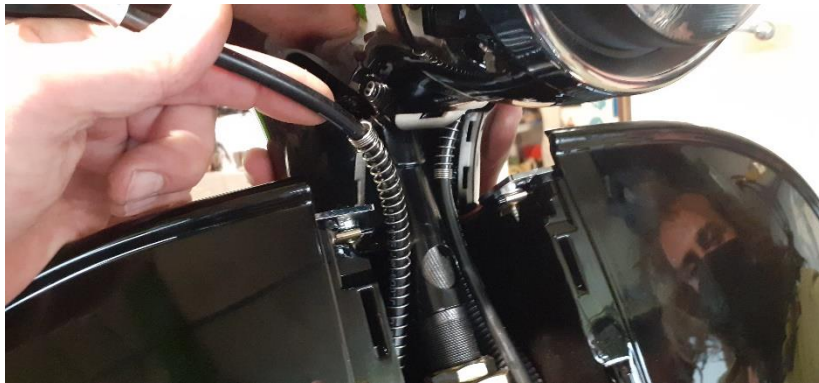
Couper les colliers qui maintiennent les durites et sortir les durites de la tête de fourche
